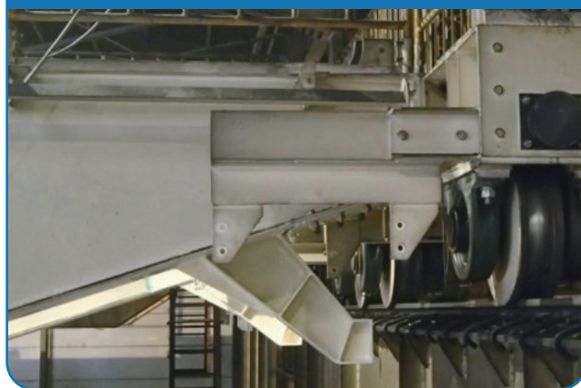
走行部 落下低減用ラグ取り付け例
